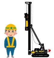
簡単に言うと建物を支える為の支柱を地中深くの支持層と呼ばれる硬い地盤に打込む工事です。まずは地面に穴を掘り、崩れないように固めていきます。次にセメントミルクを入れて工場製作したコンクリート製の杭を打込み安定させます。これによりこの先の工事でできる基礎を支えることができます。縁の下の力持ちという言葉があるように、杭工事は非常に重要な役割を担っています。それでは、現場で実際に行われている杭工事施工中の様子をご紹介します。
